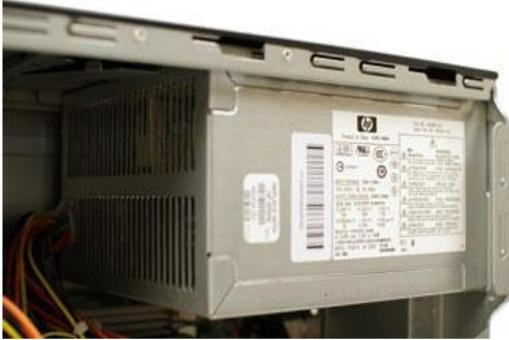
Unit suplai daya mempunyai fungsi untuk menyuplai daya dari stop kontak ke komputer. Unit ini dapat menyuplai daya ke semua perangkat yang berada di dalam komputer.
