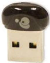
Umumnya perangkat ini terpasang *built-in* pada *motherboard* atau sudah termasuk dengan kartu jaringan nirkabel. Untuk komputer yang tidak mempunyai perangkat ini, dapat ditambahkan *adaptor bluetooth* USB (dikenal dengan *dongle*).
